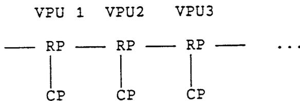
RP = Rechenprozessor, CP = Kontrollprozessor, --- = Linkverbindung
