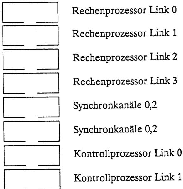
Folgende Linkstruktur ermöglicht eine schnelle Kommunikation zwischen den beiden Prozessoren einer VPU und ein problemloses Nachladen von Anwendungsprogrammen bei laufendem TIP-BUS:
